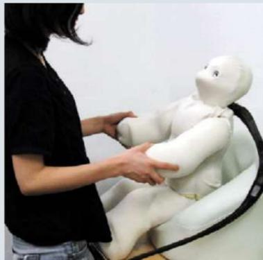
大学院時、外装の柔らかさが人間の印象に与える影響や、外装のセンサ触覚がロボットの機能面へ与える影響を調べる実験の目的で作ったロボット
